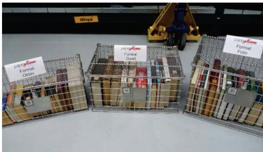
Obr. 3: Klece různé velikosti podle formátu knih pro transport a proces odkyselování metodou Papersave Swiss. Foto: Jitka Neoralová
